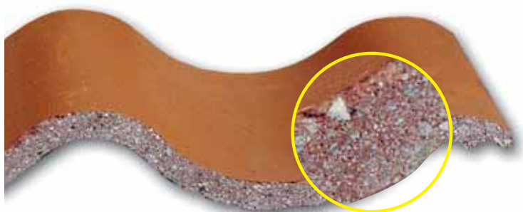
Concrete roof tile (above) in comparison to clinker roof tile (below): Tuile en béton (haut) en comparaison avec la tuile en clinker (bas)
