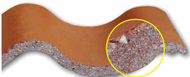
Betondachstein (o.) im Vergleich zum Klinkerdachziegel (u.):
